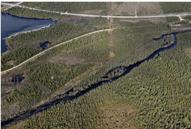
Flygbild över Vassaraälven (källa: Gällivare kommun, 2013). Flygbilden är tagen vid vårflöde. Notera älvens sidofåror, som vid höga flöden visar på älvens tidigare utformning. Under flottningsepoken eftersträvade man att stänga av sidofåror för att underlätta transporten av timmer. Det har inneburit att sidofåror ofta är torrlagda vid normala vattennivåer.
